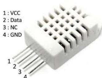
Pour pouvoir l'utiliser avec un **Raspberry Pi**, il faut le relier par exemple via la broche **Data** à **GPIO6**, la broche **VCC** à **3.3V** (ou **5V**) et la broche **GND** à **GND**. Et il faut mettre une **résistance de rappel** de 4.7 kohms à 10 kohms entre **VCC** et **Data**.
