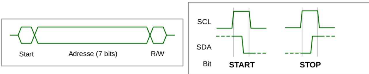
Pendant toute la durée du créneau haut du signal d'horloge **SCL**, le signal de données **SDA** doit être maintenu au niveau haut ou bas suivant que l'on transmet un 1 ou un 0.
