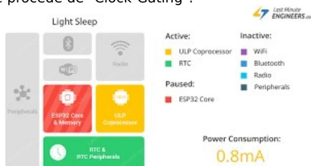
Avant d'entrer en mode **light sleep**, L'**ESP 32** garde en mémoire les données et reprendra l'exécution du code là où il s'est arrêté. L'avantage de ce mode est qu'il permet un réveil rapide tout en économisant de la batterie.
